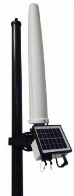
Figura 1. Immagine della stazione di monitoraggio a larga banda per campi elettrici e magnetici NARDA AMB 8059-03.
